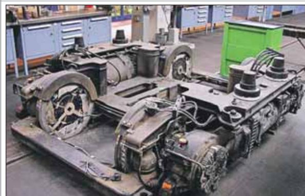
Для постройки низкопольных трамваев обычные двухосные тележки (как на железной дороге) не подходят. Они не позволяют опустить пол ниже осей. Нужны особые тележки, где каж-
