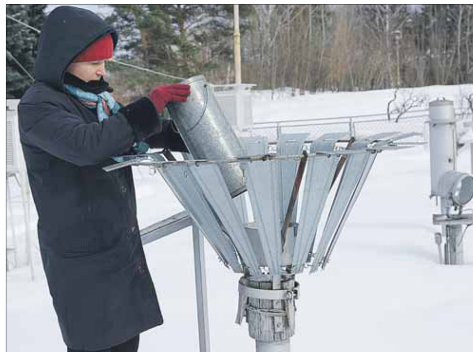
Самый необычный из приборов — похожий на металлический цветок осадкомер Третьякова
