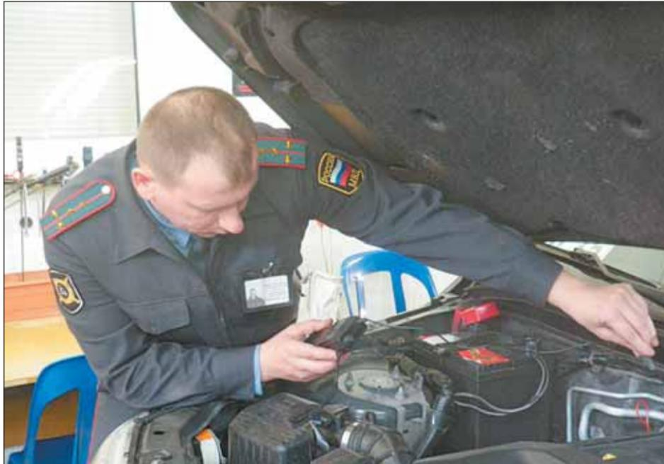
Подлинность маркировки кузова проверяют специальным прибором
