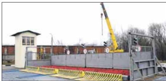
Производительность снеготаялки 7 тысяч кубометров снега в сутки
