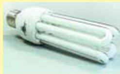
**Люминесцентные лампы** — это закрученные, как улитка, или согнутые в виде буквы U стеклянные трубки, заполненные парами ртути. Изнутри стенки трубки покрыты светящимся веществом — люминофором. Лампа горит из-за того, что между двумя электродами, расположенными в противоположных концах трубки, возникает электрический разряд.
