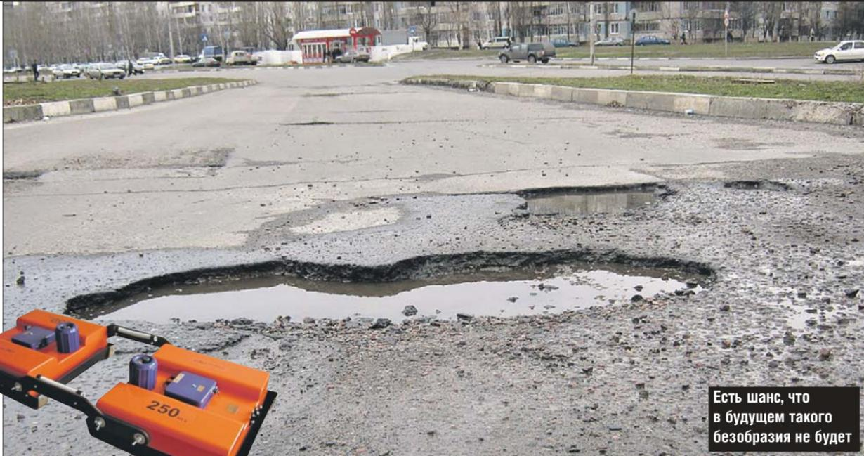
**Этот прибор позволяет заглянуть вглубь с помощью отражённых радиоволн**
