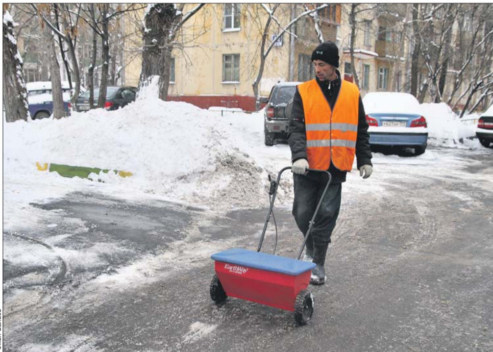
Реагенты должны рассыпаться ровным слоем, для этого применяют тележки с дозатором
