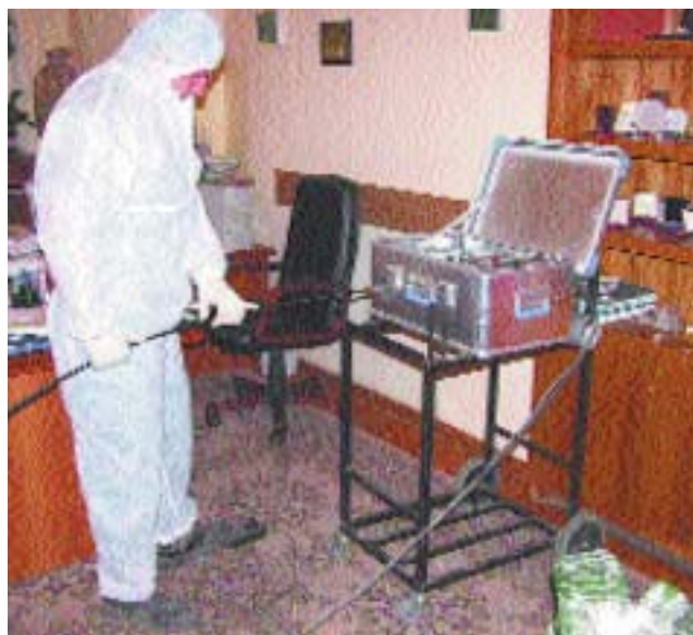
Так проверяют чистоту воздуха в вентсистемах
