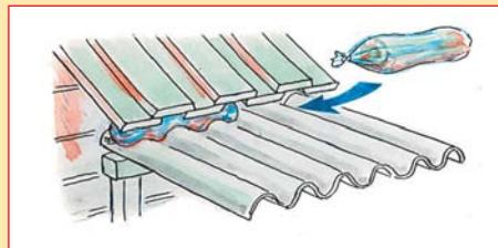
«Кляпом» из куса поролона, помещенного в полиэтиленовый пакет, можно быстро заделывать щель, ликвидировав протечку кровли.
