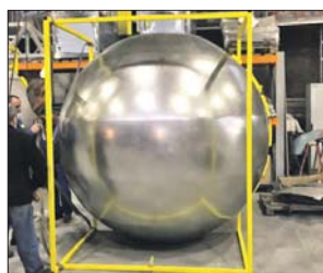
Шары из нержавеющей стали имеют диаметр 2,5 метра
