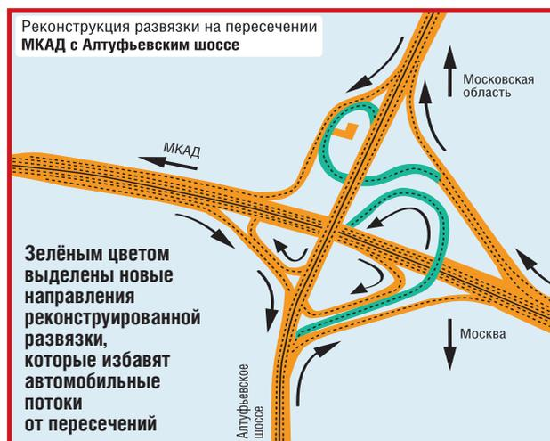
разгона. Благодаря этому машины не будут мешать основному потоку на МКАД.
