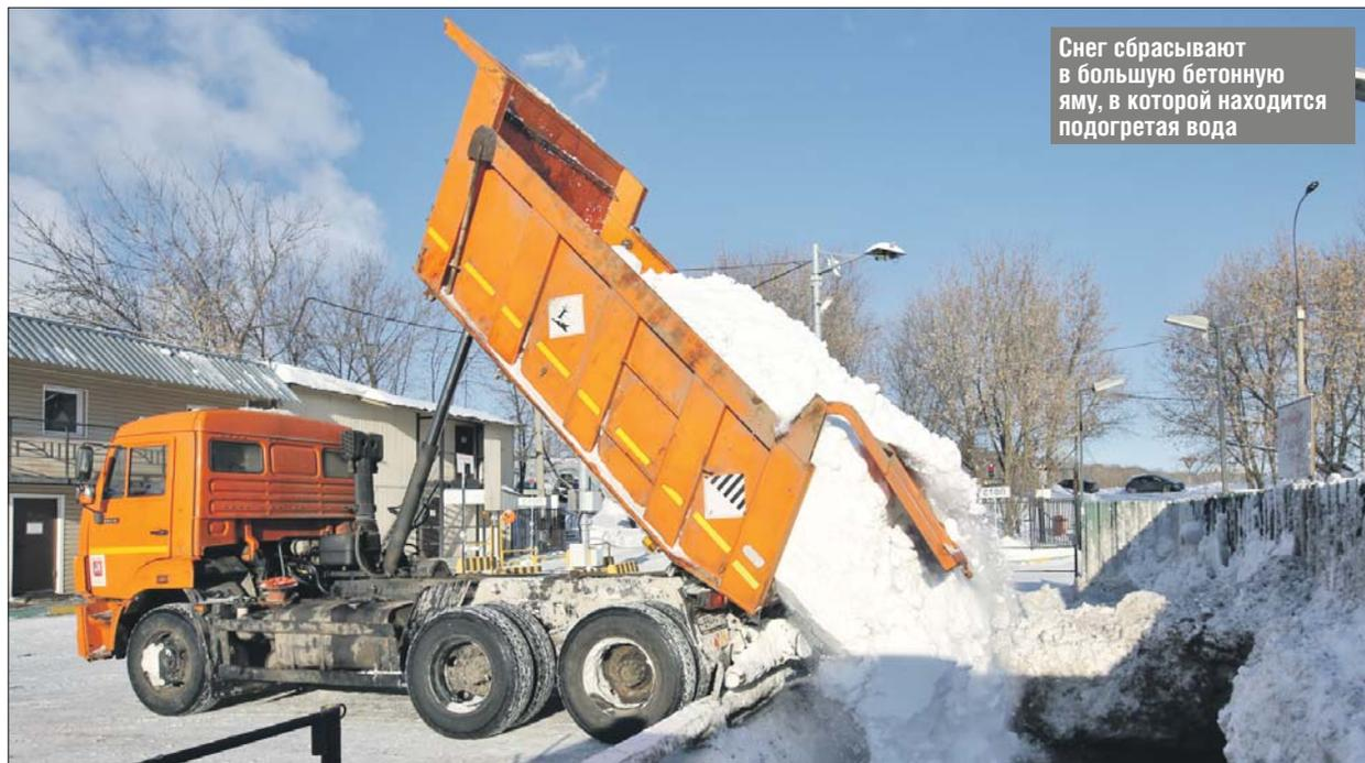
Снег сбрасывают в большую бетонную яму, в которой находится подогретая вода
