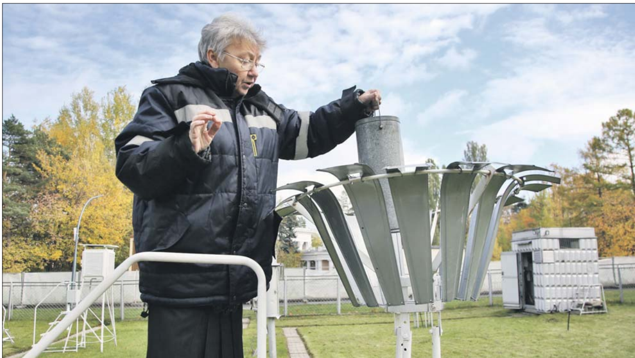
Начальник метеостанции Светлана Никитина показывает устройство, которое используют для измерения количества выпавших осадков
