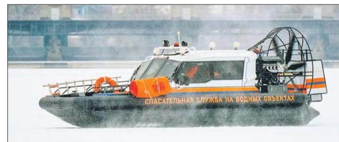
Суда на воздушной подушке могут передвигаться по воде, болоту, льду
