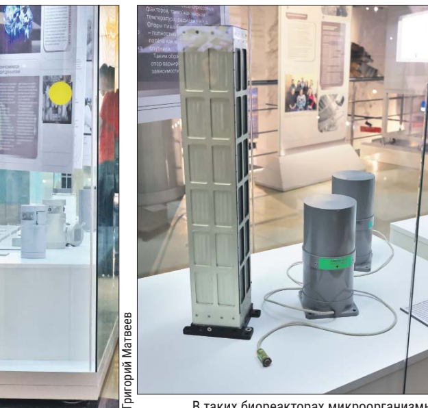
В таких биореакторах микроорганизмы перерабатывают пластик и целлюлозу
